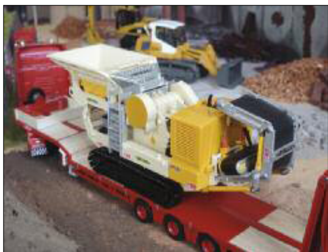
■ I cingoli sono in metallo per un'ottima traslazione dell'impianto sia per la movimentazione in cantiere che per il carico/scarico dello stesso dai pianali di trasporto
