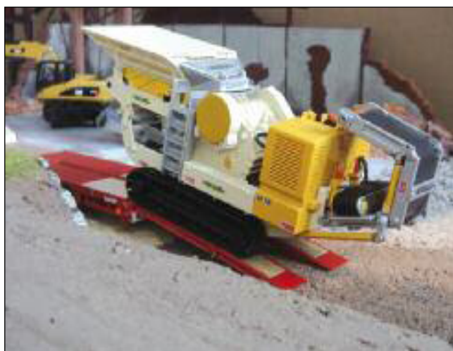
■ I cingoli sono in metallo per un'ottima traslazione dell'impianto sia per la movimentazione in cantiere che per il carico/scarico dello stesso dai pianali di trasporto
