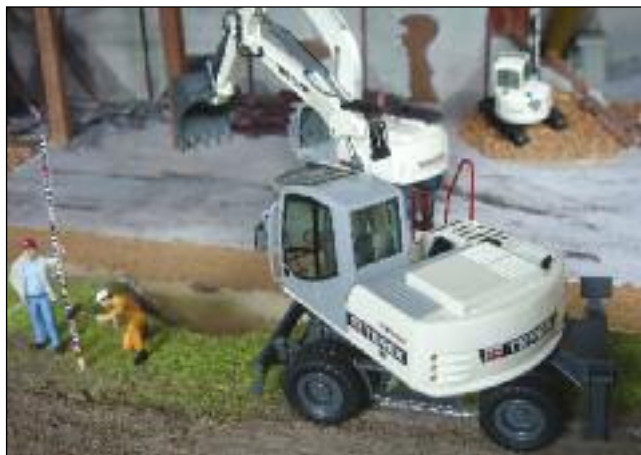
■ Il Terex TW140 è l'escavatore gommato triplice con lama e stabilizzatori mobili; ben curato il braccio e la benna da scavo
