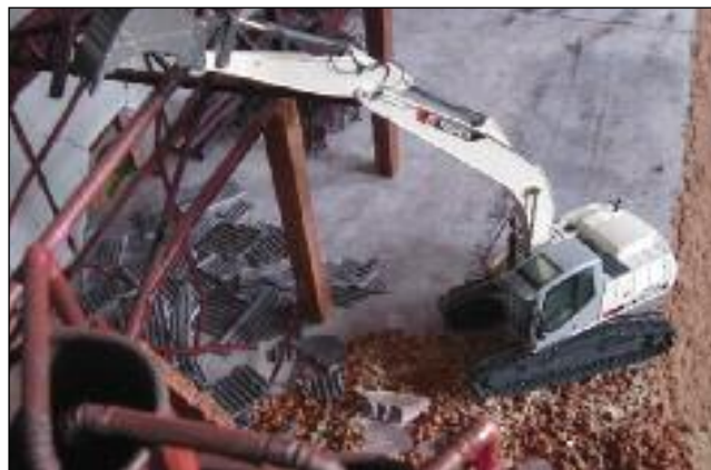
■ Il cingolato TC225 LC presenta boomerang più lungo rispetto allo standard, è ben bilanciato nei pesi per un'ottima stabilità, data anche dal carro cingolato dalle dimensioni rapportate all'allestimento
