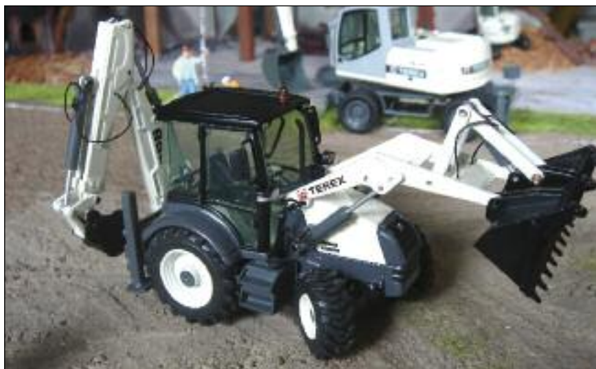
■ Tra le caratteristiche salienti della terna 860SX: asse sterzante inclinabile, ottimo diametro di rotazione, braccio da scavo che ben rientra in sagoma, con possibilità di allungamento del penetratore
